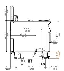
Electrical inlet (power) EQ Equipotential screw
